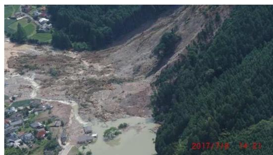
写真-1.3 大量の土砂で埋積された河道
