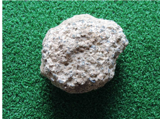
通潤橋 導水管の止水材としての漆喰
